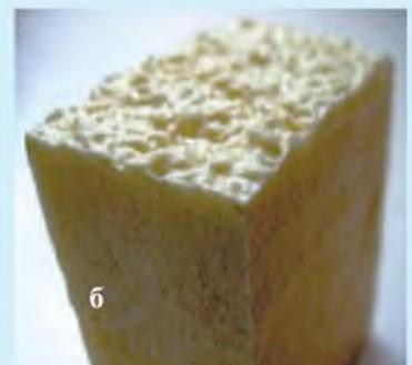
Рис. 8. Открытоячеистая (а) и закрытоячеистая (б) пенополиуретановые композиции
