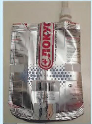
Рис. 2. Внешний вид реактор-пакета, содержащего полиольный и изоцианатный компоненты, разделенные перегородкой
